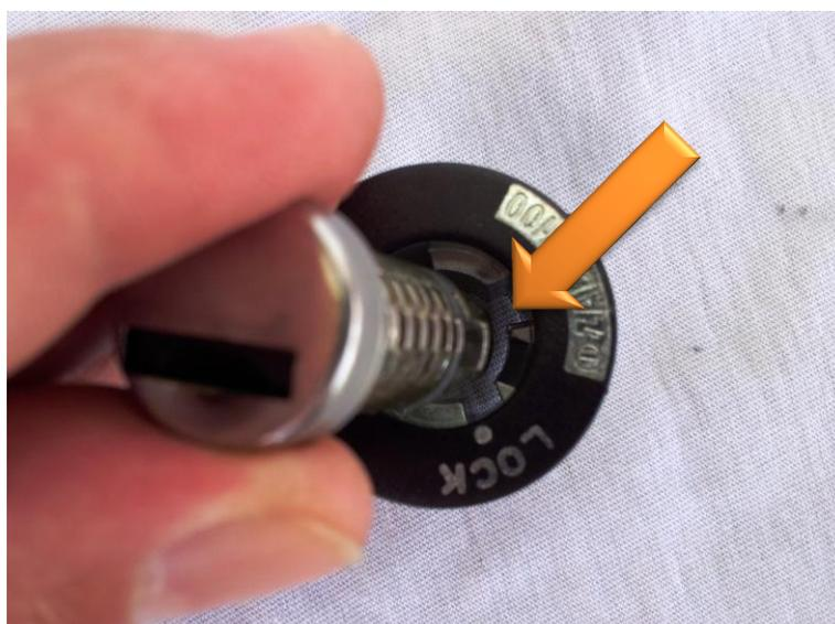
Wenn der Zylinder nun in der Schlossaufnahme komplett eingedrückt wurde, kann dieser in die zuvor gefettete Zündschlosshalterung eingesteckt werden (Zündschlüssel auf Stellung > OFF <).
