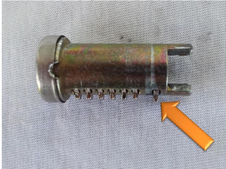
Der Sperrzapfen am Ende des Zylinders wird hierzu über eine geführte Rampe in die Schlossaufnahme gedrückt (der Schlüssel steck hierzu im Zylinder).
