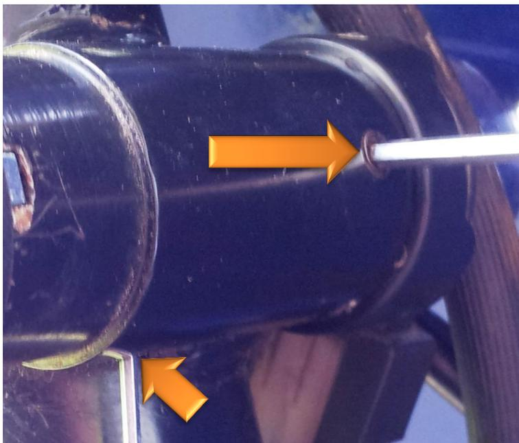
Wenn das Zündschloss nun herausgezogen wurde, kann es ausgetauscht werden oder wie in diesem Fall in die Schlossaufnahme eingesteckt werden (etwas „säurefreies“ Allzweckfett zum Schmieren des alten Zylinders schadet auch nicht). Zum Einstecken wird der Schlüssel komplett ein geführt.
