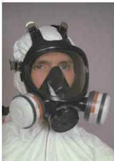
Die Spezialfilter NO-P3 und Hg-P3 sind immer Kombinationsfilter. NO-P3-Filter dürfen nur einmal zum Gebrauch kommen. Für HG-P3-Filter beträgt die maximal zulässige Gebrauchsdauer 50 Stunden. Als Anwendungsbereich gilt der schärfere Wert des Vielfachen des Grenzwertes des Gas- oder Partikelfilterteils.
